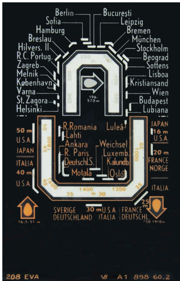
• Afstemschaal van een op de Philips 208U gebaseerd 'Verlagerungsgerät' (oude uitvoering). Het Philips-logo ontbreekt en de pijlen die naar de drie golfbereiken verwijzen zijn hoekig en strak van vorm. De onderrand van de schaal toont de schaalinformatie.
